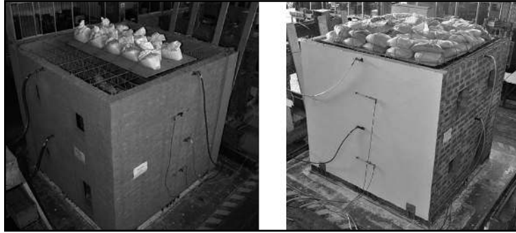
Figura 10. Prototipos de adobe y ladrillo terminados, antes del ensayo. Figure 10. Finished adobe and brick prototypes, before the testing.
