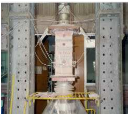
Foto 1. Compresión Axial de Pilas.
