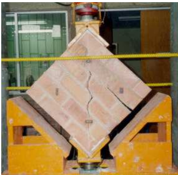
Foto 5. Falla típica en muretes Tipo Patrón, grieta que atravieza unidades.
