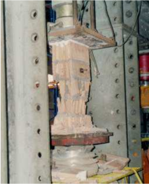
Foto 3. Falla típica de la pila Tipo Patrón y con Cemento Puzolánico.
