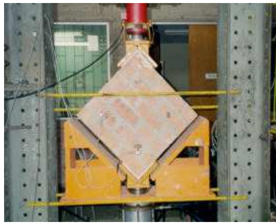
Foto 2. Compresión Diagonal de Muretes.
