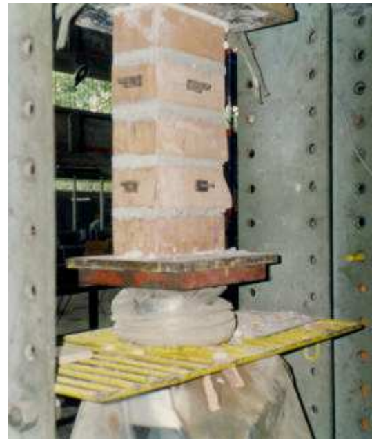
Foto 4. Falla típica de la pila con arena fina, por aplastamiento.
