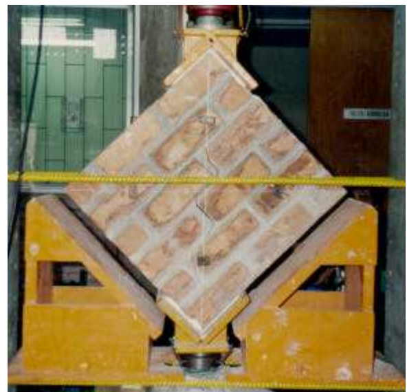
Foto 6. Falla típica escalonada en muretes con arena arena fina.
